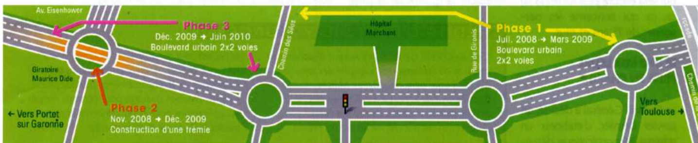
Travaux route d'Espagne : les 3 phases 2008-2010
